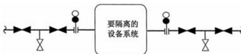
图 C.4 双阀加盲板隔离
